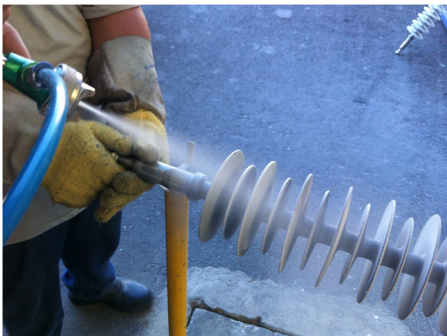
Figura 4: Aplicação da poluição por jateamento em de suspensão em superfície aquecida.
