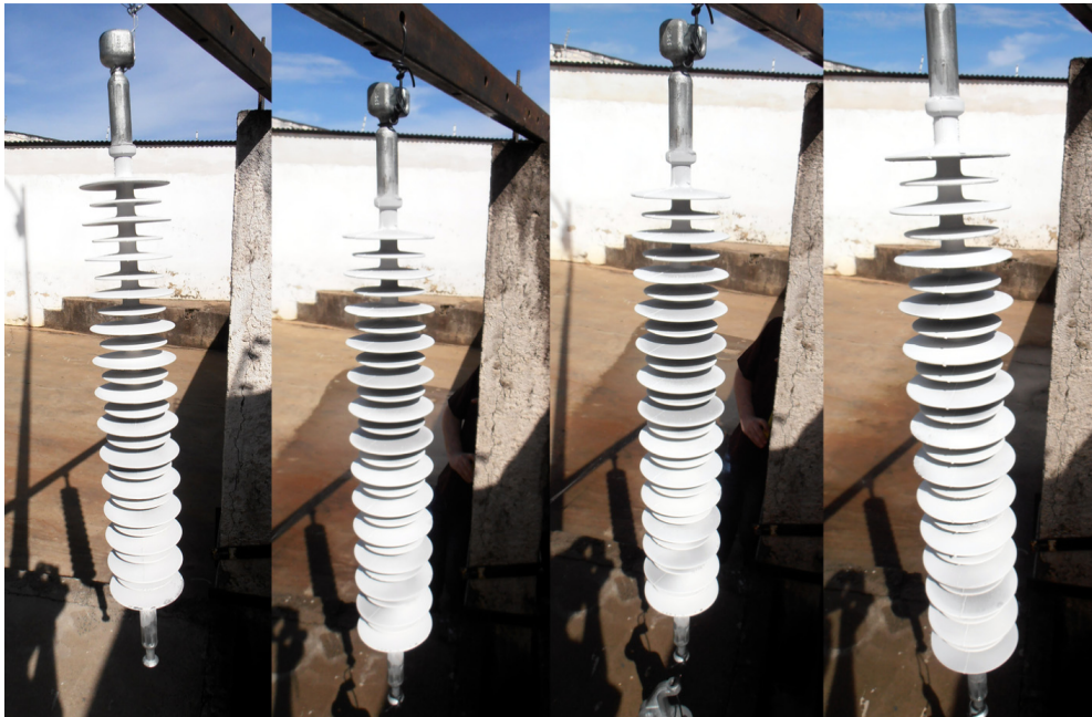
Figura 5: Isoladores poluídos artificialmente (da esquerda para direita: isoladores 1, 2, 3 e 4)
