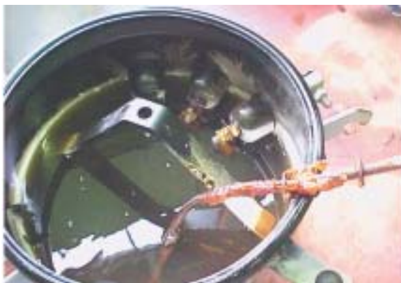
FIGURA 5. Material de degradação do fio esmaltado
