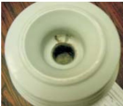
FIGURA 3 - Danos nos isoladores de pino após 4 meses no campo
