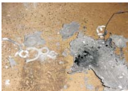
FIGURA 10 - Espaçador 1 derretido durante ensaio de compatibilidade dielétrica com cabo do fabricante 1.
