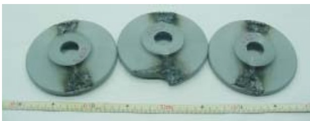
FIGURA 15 - Amostras de isoladores de pino com queima de material durante ensaio de trilhamento.v
