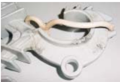
FIGURA 4 - Danos nos espaçadores após 8 meses no campo.
