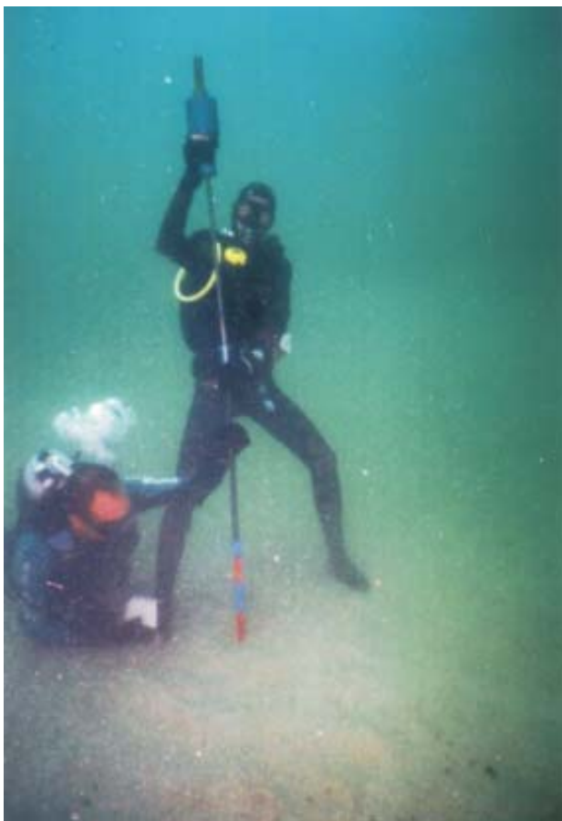
FIGURA 3 - Penetrômetro dinâmico adaptado para uso submerso.
