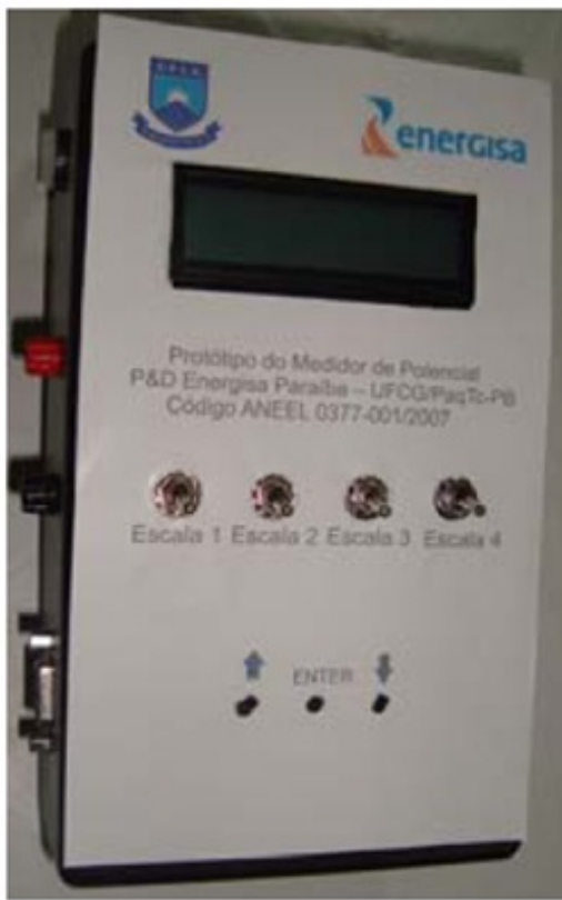
Figura 5: Equipamento de medição dos potenciais de superfície
