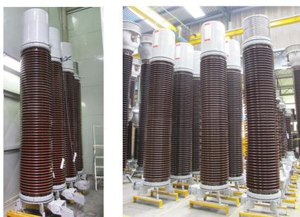
Fig. 7. Transformadores de Potencial ensaiados.
