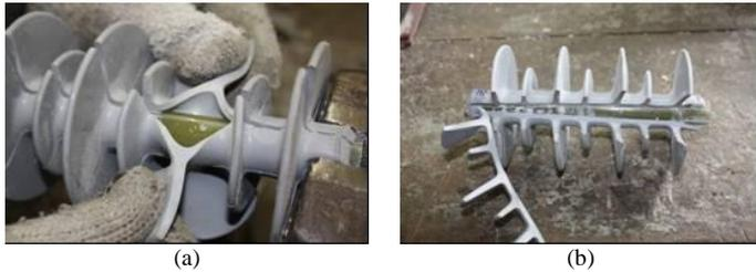
Figura 17. Isolador B: (a) esforço lateral e (b) arrancamento.
