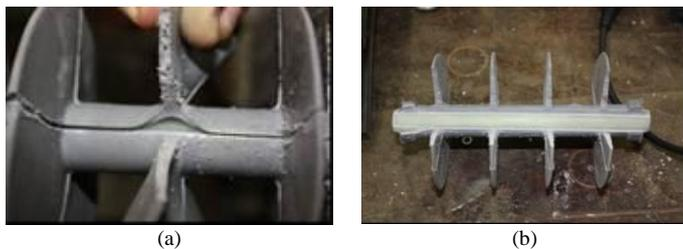
Figura 18. Isolador G: (a) esforço lateral e (b) arrancamento.
