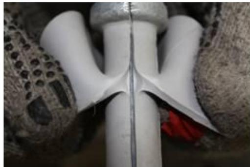
Figura 5. Teste de esforço lateral.
