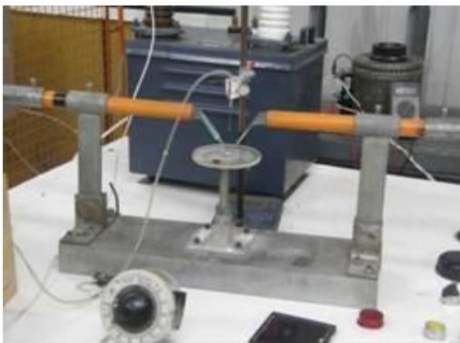
Figura 4. Trilhamento elétrico modificado: arranjo experimental.
