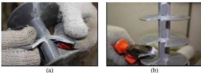
Figura 19. Isolador H: (a) esforço lateral e (b) arrancamento.
