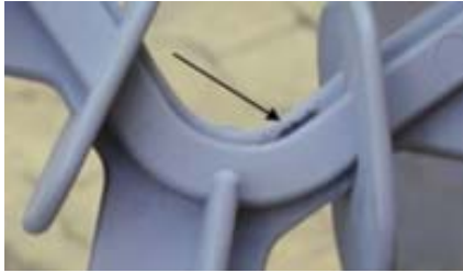
(c) Espaçador Apresentando Ponto de Trilhamento Elétrico na Superfície.
