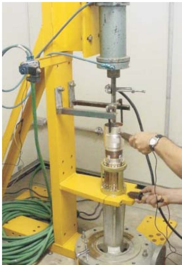
FIGURA 10. Detalhe da medição da resistência elétrica do contato.
