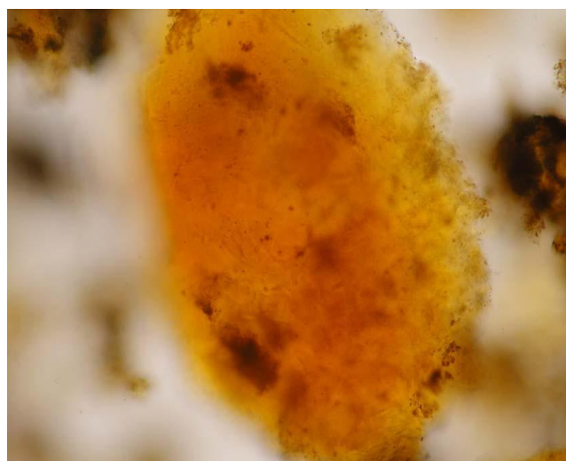
Figura 13. Detalhe do agregado biológico que constitui os flocos predominantes no material analisado (aumento de 600x).
