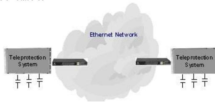
FIGURA 5. Teleprotección sobre una red Ethernet
