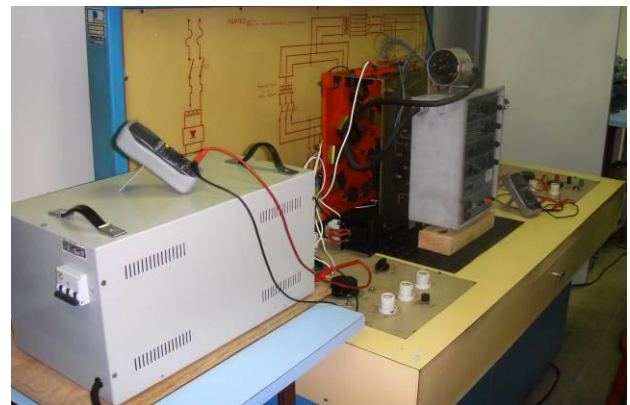
Figura 12. Vista lateral esquerda da bancada, onde é possível observar o varivolt, o reator e o regulador de tensão.
