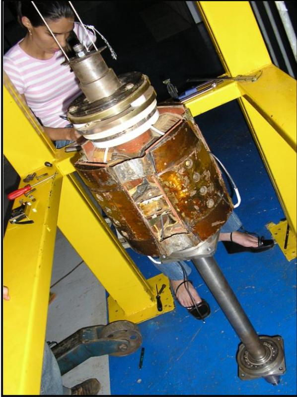
Figura 11. Ensaio para avaliar o Momento Polar de Inércia do Rotor
