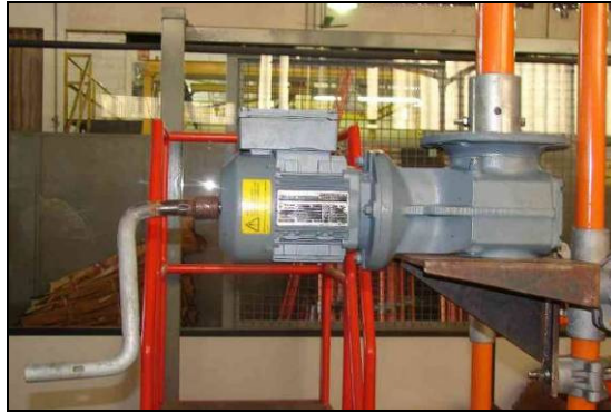
Figura 7 - Mecanismo com caixa de redução e a alavanca de acionamento manual
