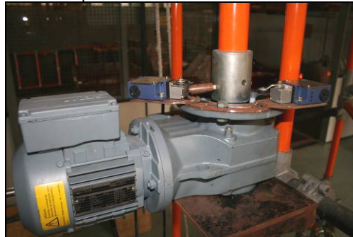
Figura 9 – Acoplamento moto-reductor haste isolante e chaves de fim de curso
