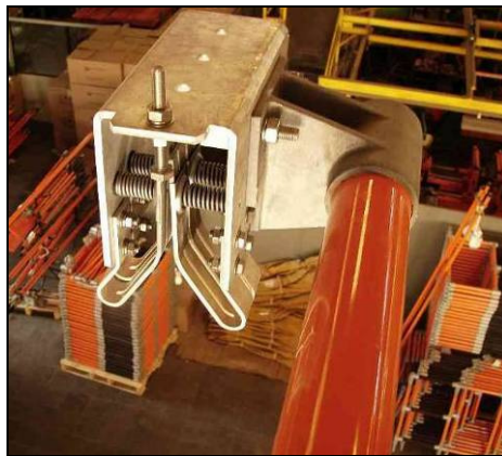
Figura 6 – Barra isolante tubular e contatos fixos
