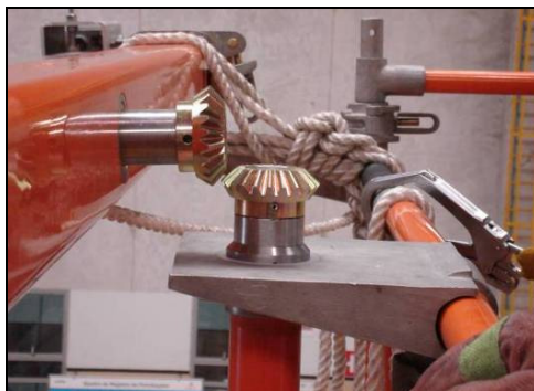
Figura 2 – Desalinhamento do acionamento devido ao excesso de peso da chave
