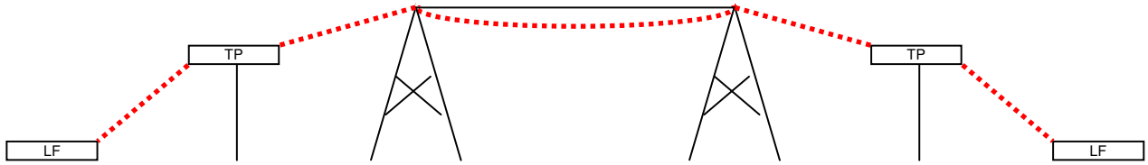
FIGURA 4: Comprimento do cabo pelo método de ondas viajantes.
