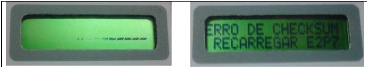
Figura 5 – Display com mau funcionamento e equipamento com indicação de erro de memória
