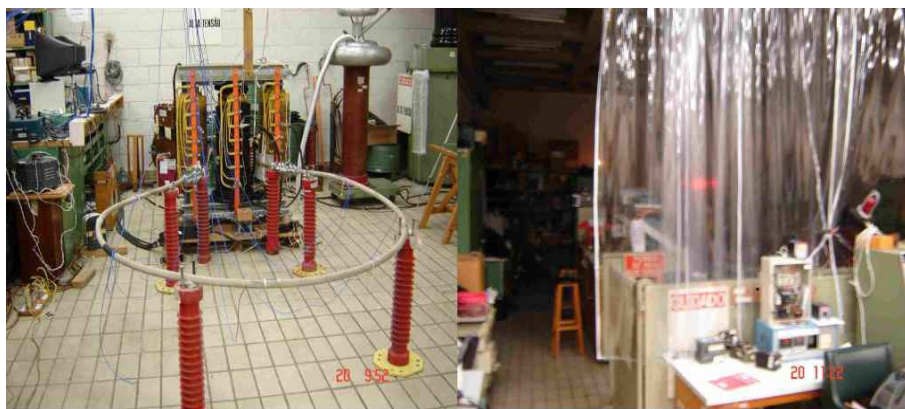
FIGURA 4. – Arranjo do ensaio no laboratório para medição indireta da emissividade do cabo
