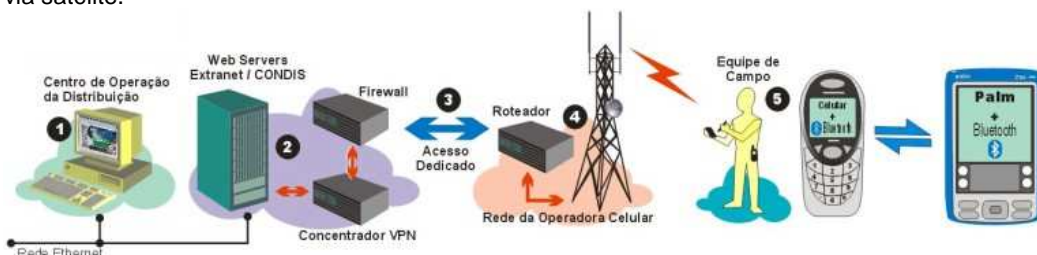
Figura 4 – Sistema de comunicação de dados via rede celular GPRS
