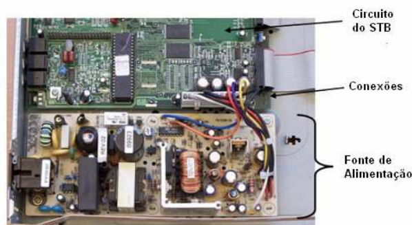
FIGURA 6 – Configuração típica do STB: fonte de alimentação separada dos circuitos funcionais do STB.
