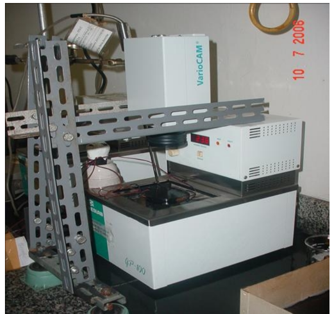
Figura 2 : Montagem do dispositivo para calibração do termovisor.
