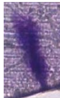
Figura 10. Micrografia de uma arborescência em água do tipo "vented".
