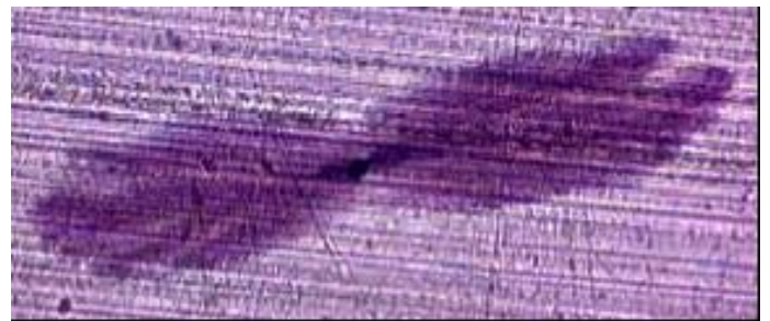
Figura 9. Micrografia de uma arborescência em água do tipo "bow tie".
