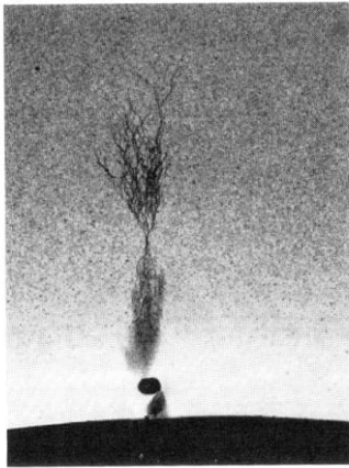
Figura 3. Conversão de arborescência em água em arborescência elétrica [2].
