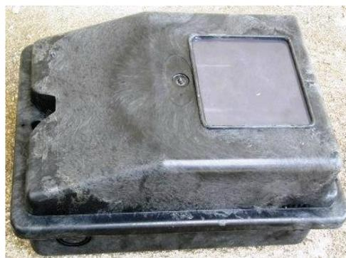
Figura 8 – Protótipo da caixa manufatura com compósito de polipropileno e fibra de sisal.
