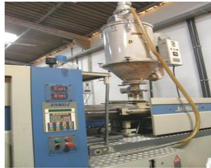
Figura 7 – Injetora Jatson utilizada para a fabricação das caixas utilizando os materiais compósitos extrudados.
