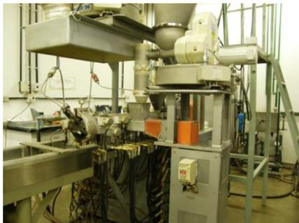
Figura 6 – Extrusora dupla rosca utilizada na preparação dos materiais compósitos.
