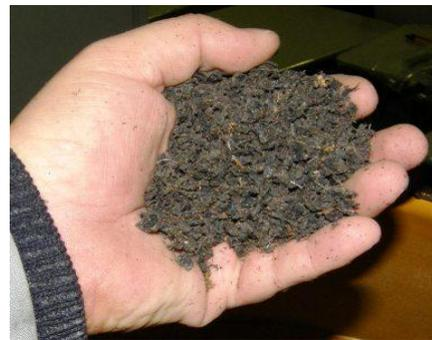
Figura 4 – Grânulos obtidos após o processo de trituração.
