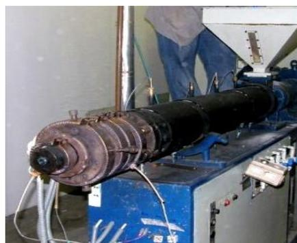
Figura 2 – Extrusora mono rosca utilizada na preparação dos materiais compósitos.
