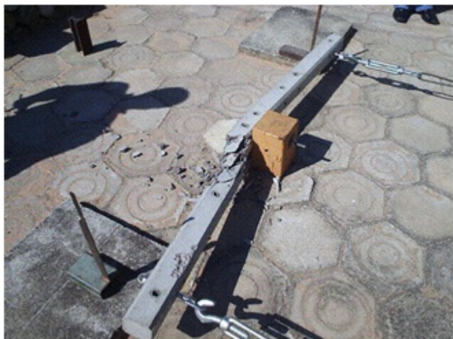
Figura 2 – Ensaio de ruptura da cruzeta
