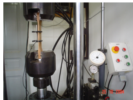
Figura 3. Ensaio de tração mecânica na madeira impregnada com a resina poliuretana RI 3.
