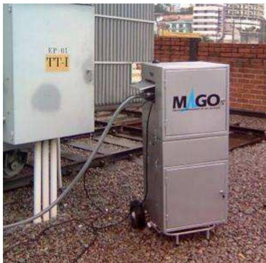
FIGURA 2 – Analisador de gás em operação(2).
