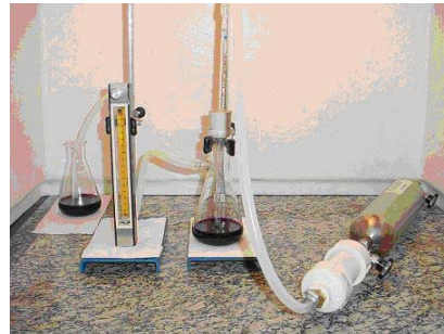
FIGURA 6 – Passagem da amostra padrão de GN contendo mercúrio pela espuma de poliuretano e posteriormente, pela solução oxidante.
