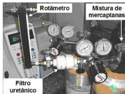
FIGURA 7 – Sistema montado para a passagem da amostra padrão de GN contendo mercaptanas pela espuma de poliuretano.
