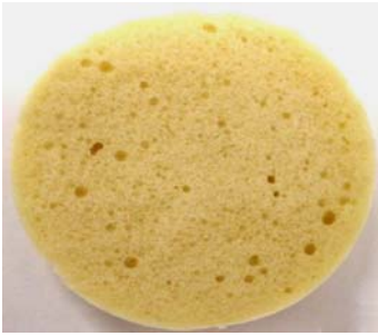
FIGURA 8 – Corte transversal da espuma flexível de poliuretano.
