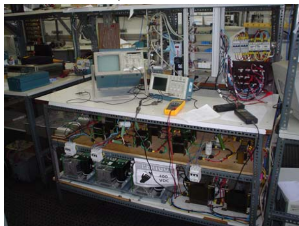
Fig. 6 UPQC Implementado em bancada
