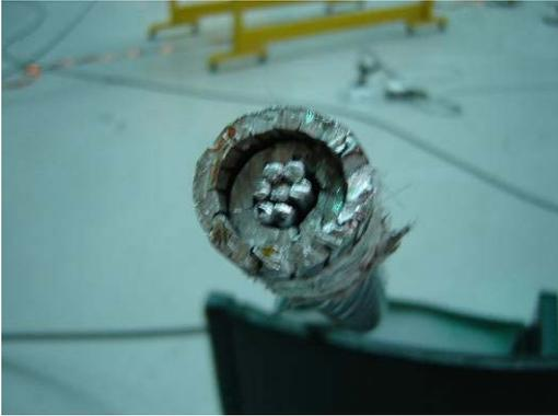
Figura 2 – Detalhe do encordoamento do cabo AERO\_Z
