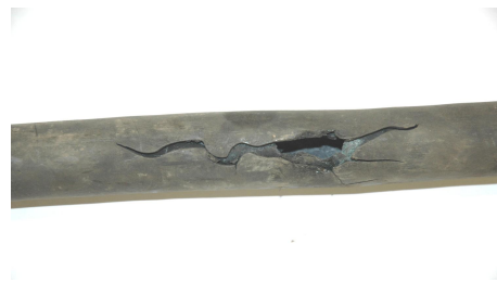
Fotos 11 e 12 : Ocorrência em utilidade e cabo subterrâneo com falha estrutural no isolamento
