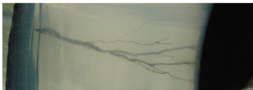
Foto 4 : Foto microscópica do fenômeno "electrical trees"
