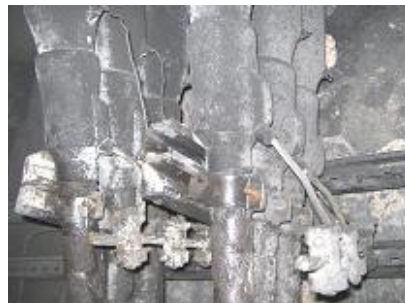
Fotos 9 e 10 : Terminais e conexões de cabos subterrâneos com falhas estruturais de isolamento
