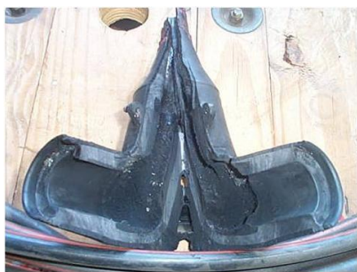
Fotos 1 e 2 : Danos a equipamentos e utilidades por falhas de isolamento elétrica
