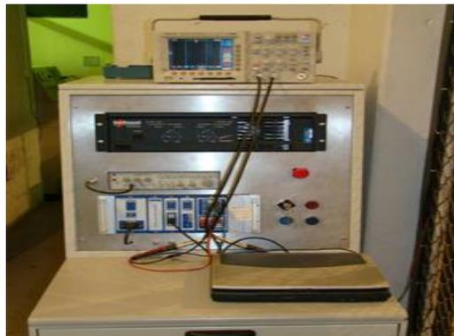
Figura 3 – Bancada com Gerador de sinais, Amplificador e Sistema de aquisição de dados.
