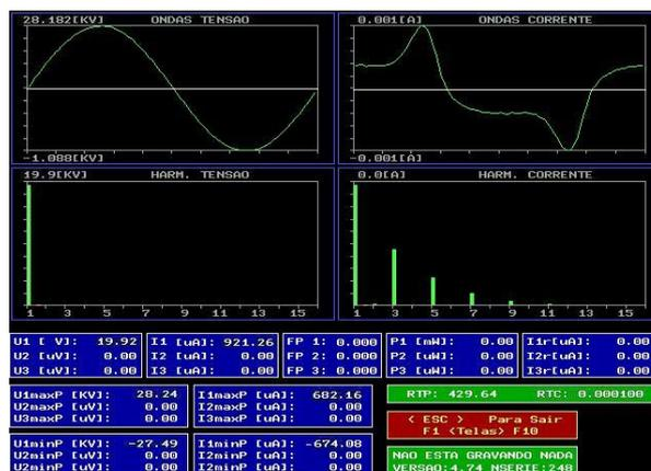
Figura 8 – Tela principal do software – para-raios de 30 kV degradado.
