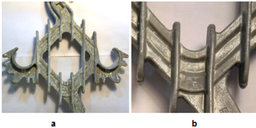
Figura 8. Suspensão de cal hidratada aplicada em espaçador de polietileno: (a) superfície seca; (b) superfície borrifada com água deionizada.
