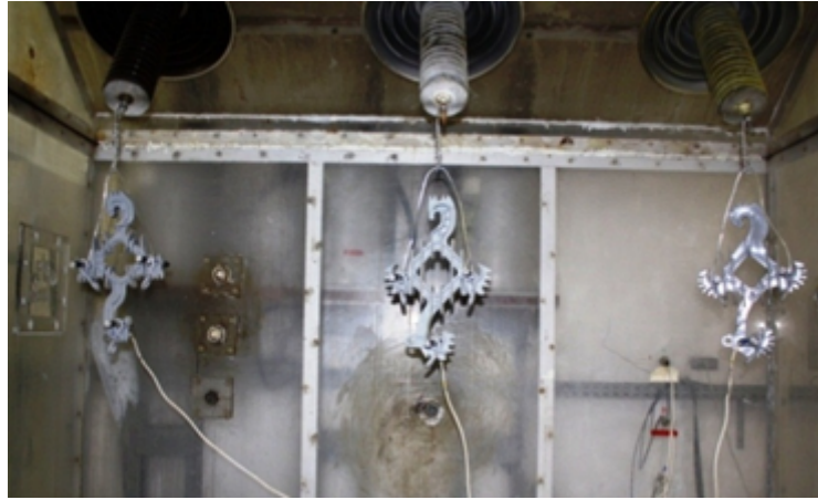
Figura 1. Espaçadores montados na câmara para medição de corrente de fuga.
