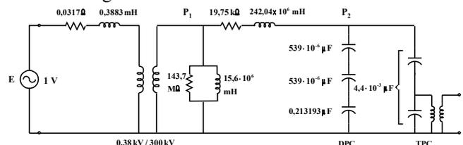
Figura 4 – Circuito de ensaio considerando o circuito equivalente do transformador elevador, divisor de potencial capacitivo (DPC) e transformador de potencial capacitivo (TPC).
