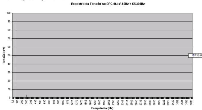
Figura 23 - Obtenção de alta tensão – 96kV em 60 Hz com 5% de 5ª harmônica (300Hz) – espectro
