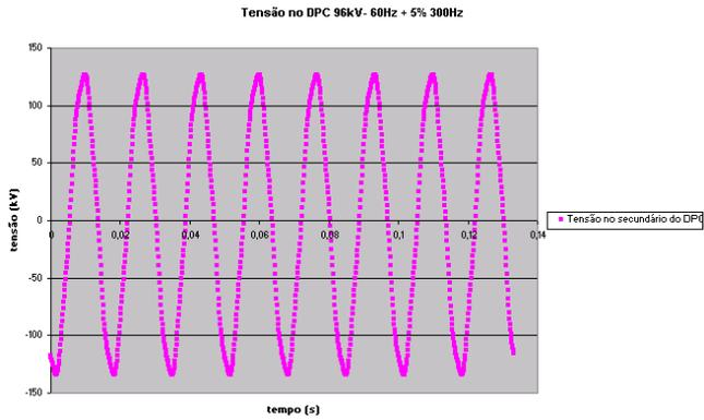
Figura 22 - Obtenção de alta tensão – 96kV em 60 Hz com 5% de 5ª harmônica (300Hz) – forma de onda
