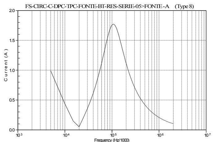
Figura 8 – Corrente exigida da fonte de tensão (fonte Califórnia) com a inserção de resistência de 0,5 Ω no lado de baixa tensão.
