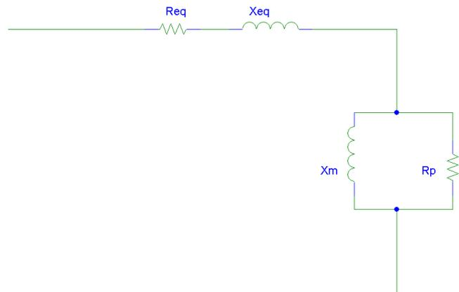
Figura 3 – Circuito equivalente do transformador elevador onde: Req – resistência equivalente, Xeq – reatância de dispersão, Xm – reatância de magnetização, Rp – resistência equivalente de perdas em vazio
