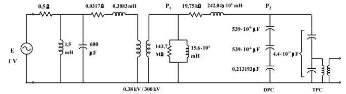
Figura 9 - Circuito de ensaio, com inserção no lado de baixa tensão, de resistência de 0,5Ω em série, e indutância de 1,5mH e capacitância de 600μF em paralelo.
