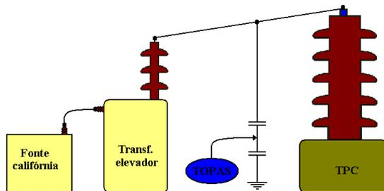
Figura 2 – Exemplo de circuito típico de calibração, mostrando fonte de tensão, transformador elevador, divisor de potencial capacitivo (Referência) e transformador de potencial capacitivo (objeto sob ensaio)
