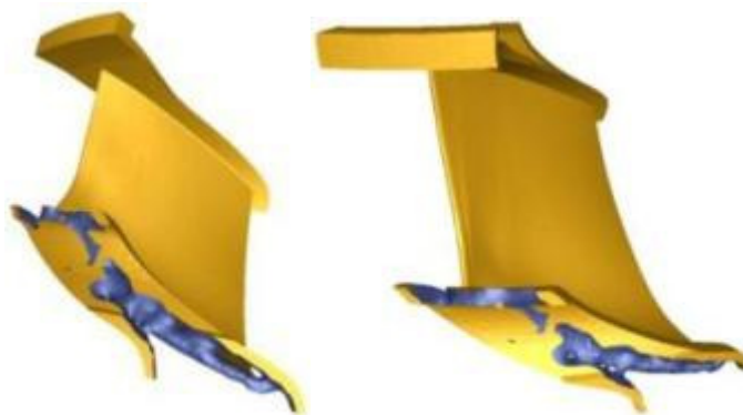
Figura 11 - Resultado pós-processado da turbina otimizada considerando todos os carregamentos e restrição de volume de material igual a 80%.
