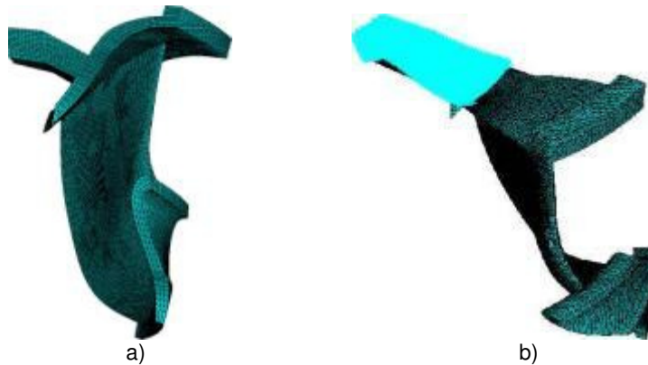
Figura 2 - a) Malha gerada para a seção cíclica; b) Condições de fixação mecânicas.
