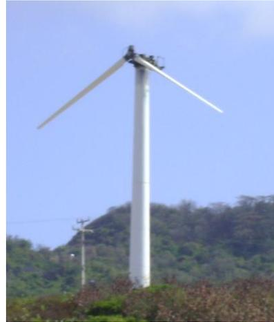
Figura 3. Turbina eólica danificada pelo raio
