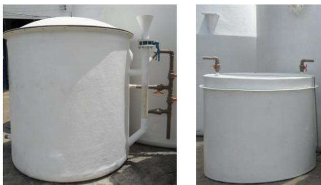
Figura 8. Biodigestor e Gasômetro levados para Noronha
