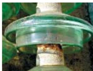
FIGURA 1. Isolador antipoluição com corrosão.
