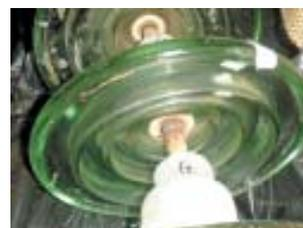
FIGURA 2. Isolador comum com corrosão.
