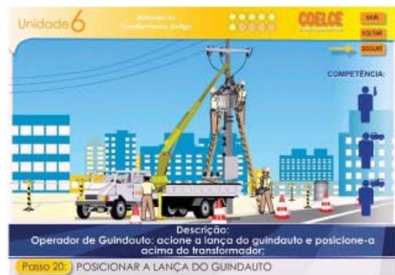
FIGURA 3 – Tela do programa treinamento para o procedimento Substituição de Transformador com o Auxílio de Guindauto.
