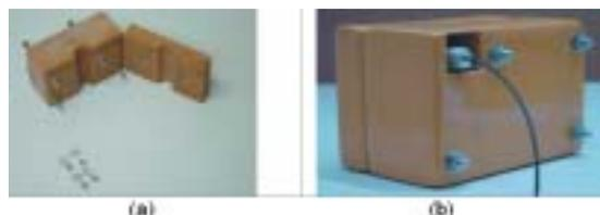
FIGURA 10 - Fotografias do TC do Sistema Permanente. (a) aberta mostrando as extremidades do núcleo do transformador; (b) vista inferior caracterizando a conexão com a POE.
