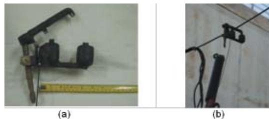
FIGURA 9 - Fotografias do TC do Sistema Temporário. (a) Garra articulada aberta; (b) Garra fixada com vara de manobra no fio.
