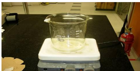
Figura 5B. Fotografia do ensaio mostrando o agitador térmico em destaque, interrogador óptico e micro.
