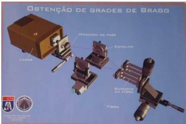
Figura 1A. Esquema para a fabricação das FBGs.
