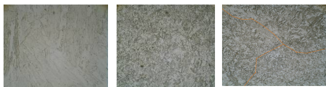
Figura 5. Macrografia do aço soldado segundo a temperatura de interpasse de 150°C.
