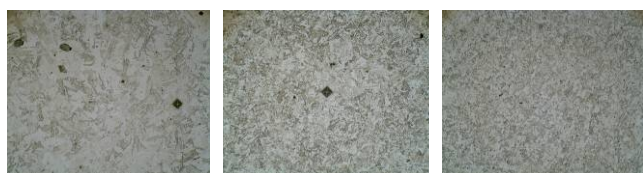
Figura 4. Micrografia das regiões analisadas do interpasse de 80°C em um aumento de 500x.
