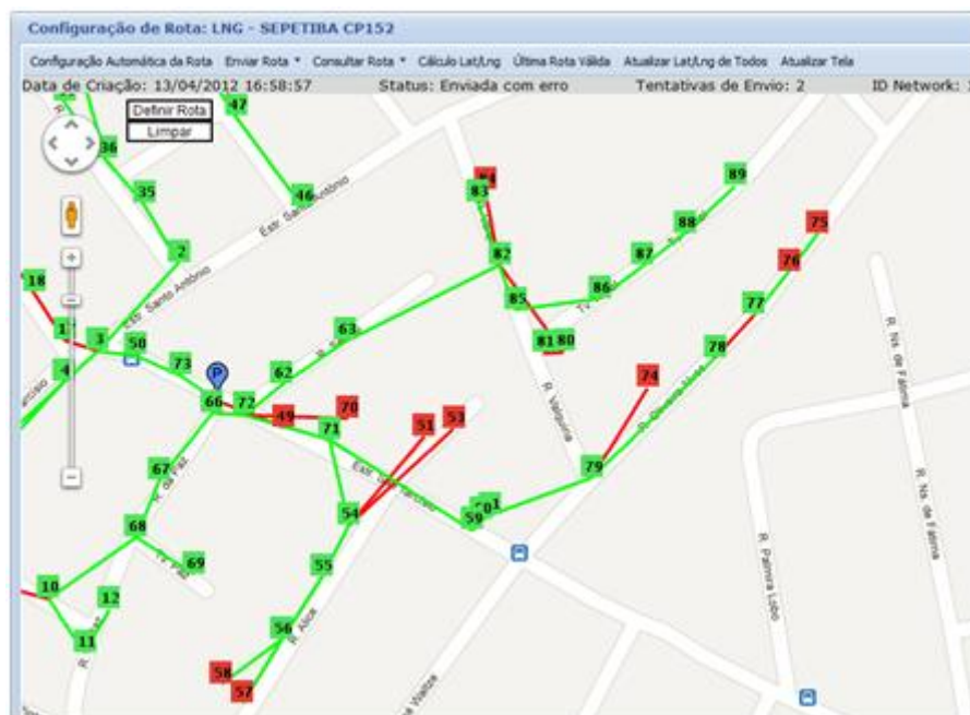
Figura 5: rede de comunicação demonstrando CS sem comunicar e caminho RF
