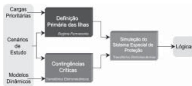
FIGURA 2. Desenvolvimento do Sistema para Conservação de Cargas
