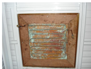
Figura 19. Detalhe interno da cavidade de referência já instalada no trailer
