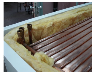
Figura 6. Isolamento térmico em lã de vidro e caixa protetora
