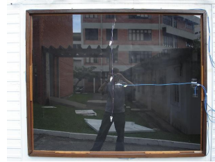
Figura 25. Vidro 3mm instalado para a calibração da cavidade principal
