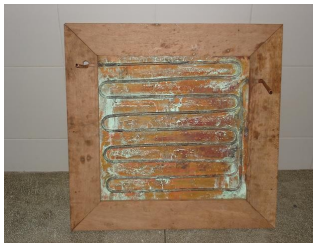
Figura 7. Vista posterior da cavidade de referência (detalhe da serpentina)
