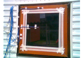
Figura 26. Vidro 3mm permanentemente instalado na cavidade de referência
