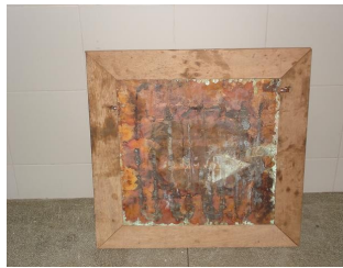
Figura 8. Vista frontal da cavidade de referência (detalhe do plano de colagem dos fluxímetros)
