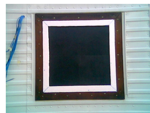
Figura 20. Vista externa da instalação da cavidade de referência (sem o vidro)
