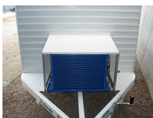
Figura 15. Sistema condensador instalado na plataforma dianteira do trailer
