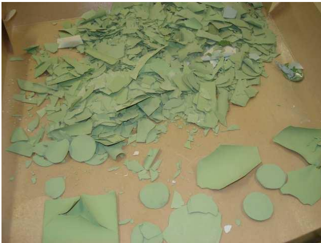
Figura 3 – Eletrodos danificados no processo de síntese.
