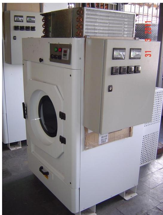
Figura 3. Secadora industrial a bomba de calor com resistor. Vista da frente e do painel lateral de controle.
