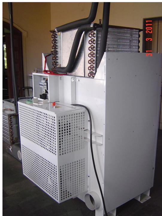
Figura 4. Secadora industrial a bomba de calor com resistor. Vista da traseira e do condensador acima..
