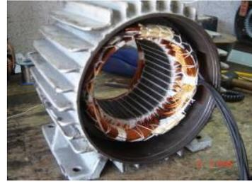
Figura 18 - Esquema de taps em um indutor de MIT adaptado para simulação de curto-circuito no seu enrolamento
