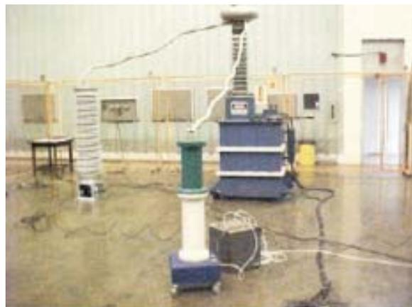
FIGURA 5 - Calibração do TP Ótico no laboratório.
