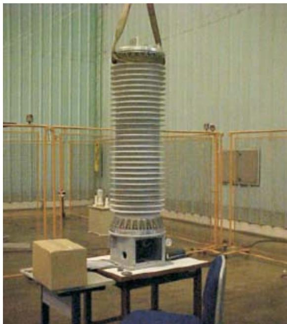
FIGURA 3 - Transformador de Potencial Ótico (138kV e 69kV)
