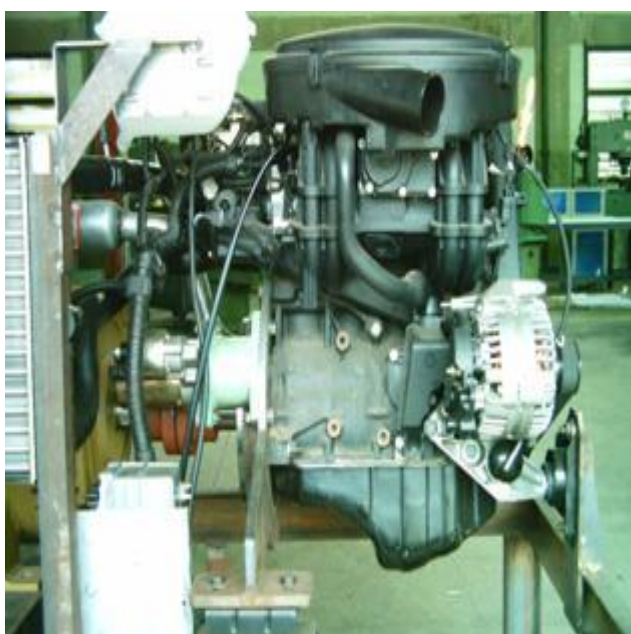
Figura 1. Grupo motor-gerador à álcool hidratado montado no projeto.
