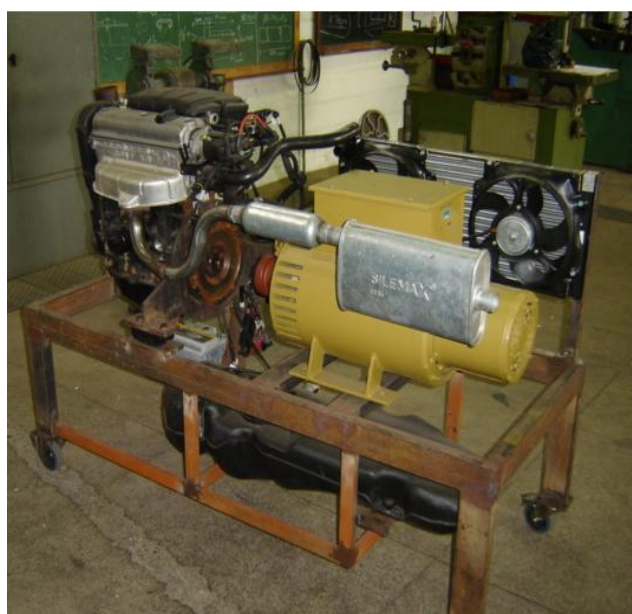
Figura 3. Grupo motor-gerador à álcool hidratado montado no projeto.
