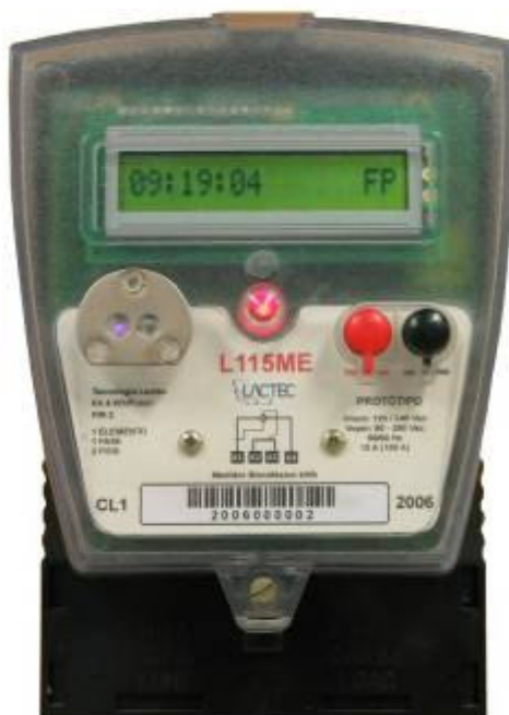
Figura 1. Medidor monofásico de energia com pré-pagamento.
