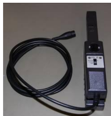
Figura 16 – Sensor de efeito Hall em formato de alicate amperímetro
