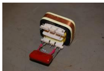
Figura 13 – Transformador de Corrente especial para medição em baixa frequência (TC-2)
