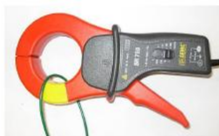
Figura 30 – Detalhe da faixa amarela indicando o melhor posicionamento do condutor
