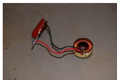
Figura 14 – Transformador de Corrente Toroidal (TC-3)
