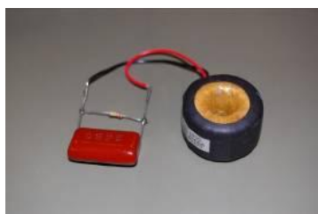
Figura 12 – Transformador de Corrente especial imune a ruídos externos (TC-1)
