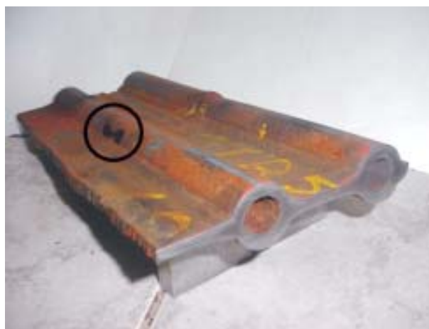
FIGURA 1. Aspecto da amostra de tubos examinados, observando-se o furo no lado fogo ( região circulada).
